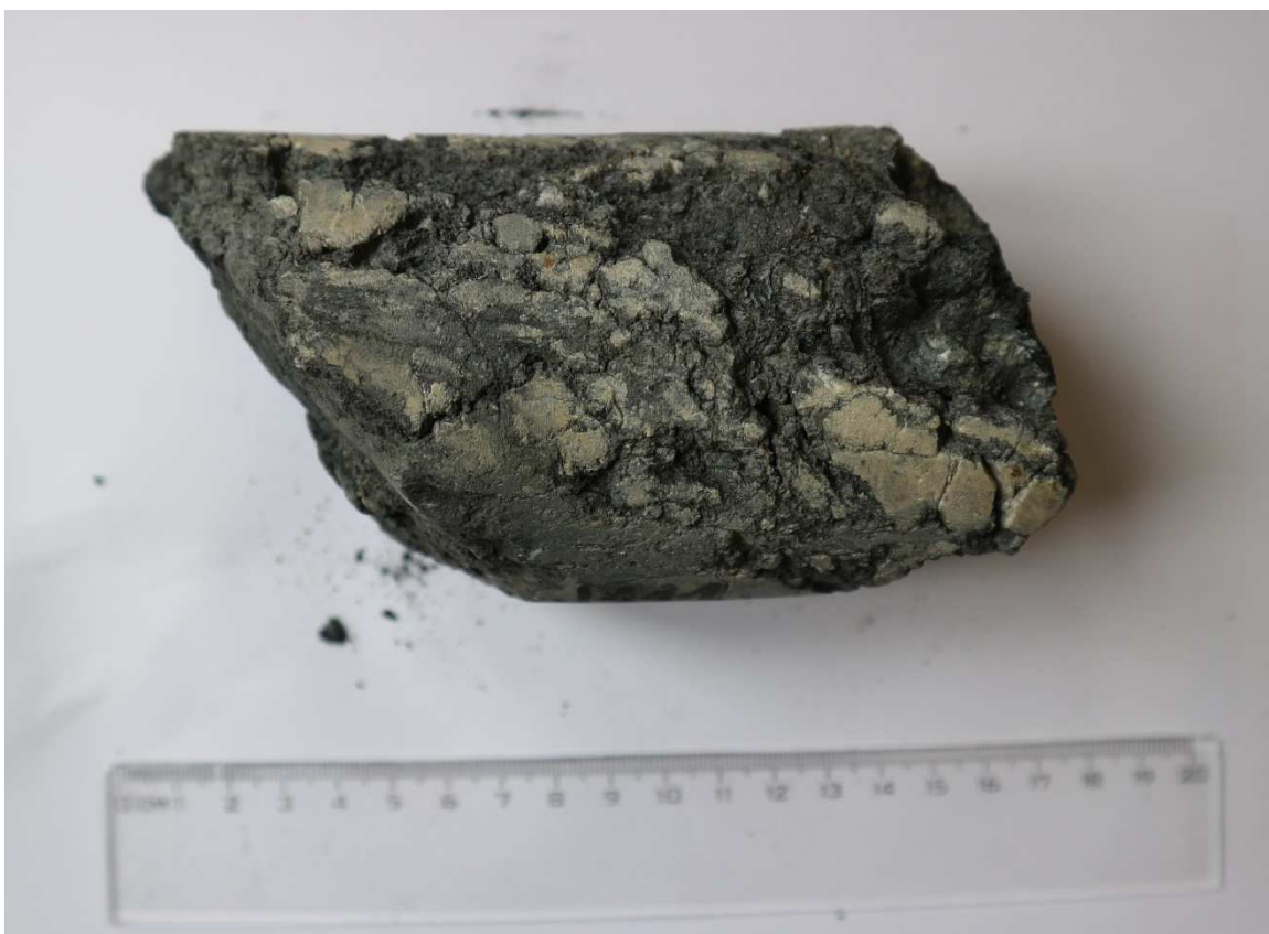
Obr. 21: Tektonicky porušené proterozoické horniny z vrtu J111
